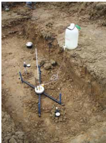
Fig 4 Strumentazione fissata. Si noti il TEG sul fondo e i due tensiometri posti alle profondità della fase 1 e 2.
