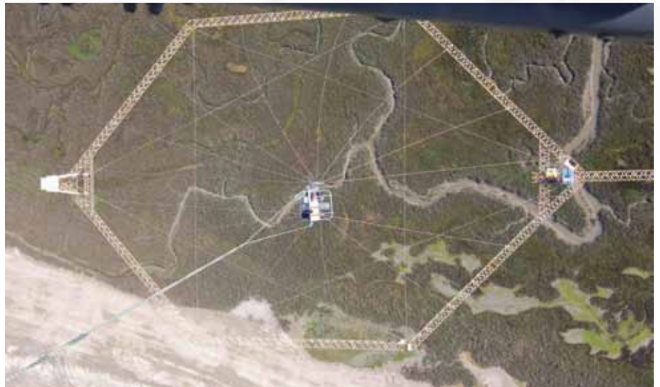
Foto 2: Il sistema SkyTEM visto dall'elicottero. Il loop trasmittente presenta una forma esagonale, di lato pari a 22 m. Al centro l'unità ricevente che registra i dati ed il generatore di corrente. Sulla sinistra si vede il coil ricevente.
